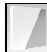
7. Para la frecuencia de **1000Hz**, es la pantalla constituida a partir del **motivo elemental 20**, Paraboloide, radio 460mm, sustracción regular, la que mejor atenúa el sonido, con una atenuación de 10,2 dB.
