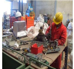
En este momento se retiran manualmente las piezas metálicas contenidas en el interior del tubo y se procede a retirar el fósforo que se encuentra en la parte frontal del tubo con ayuda de un aspirador especial provisto de filtros para retener y almacenar esta sustancia tan nociva. El vidrio delantero y el trasero se almacena de forma separada.
