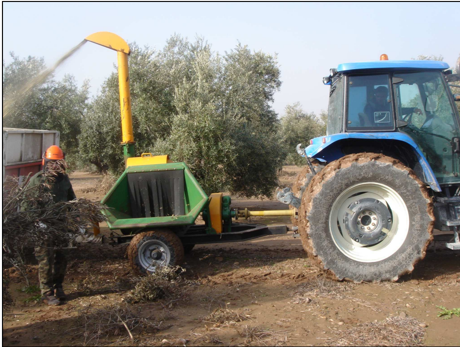
Fotografía nº 2. ASTILLADO DE RESTOS DE PODA DE OLIVAR
