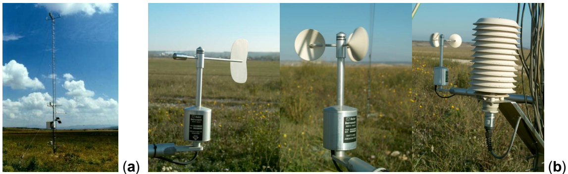
Figura 1. Torre meteorológica de 9 m (a) y detalle de los sensores (b).
