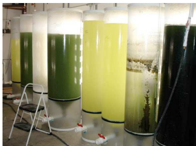
Figura 4: FBR cilíndricos verticales del Centro para la Biotecnología de las Algas de San Diego.
