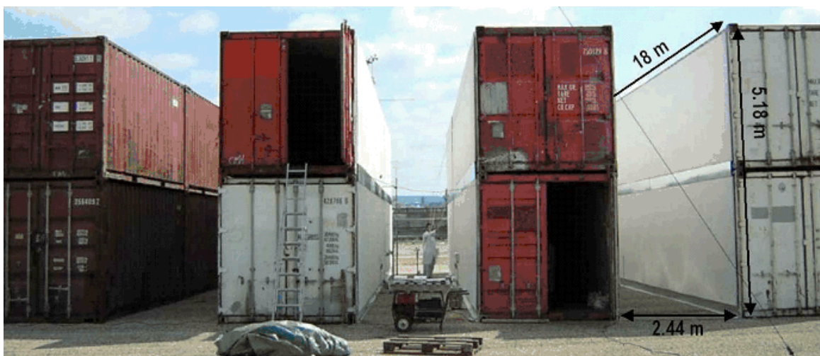
Diseño del Proyecto PICADA, simulando configuración de calles urbanas a modo de "street canyon"
