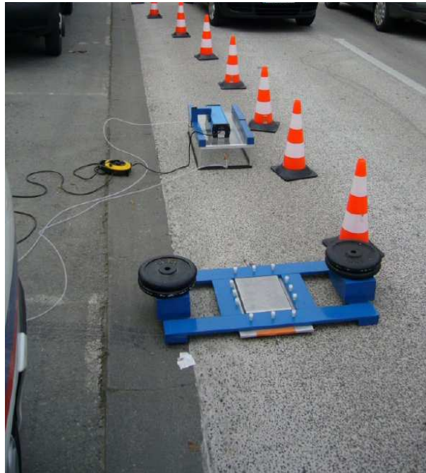
Ensayo "in situ" de determinación de eficiencia fotocatalítica
