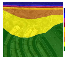
Simulación sin barrera para LeqA de una hora en el caso peor, barrera de 2 m de altura, barrera de 3 m de altura
