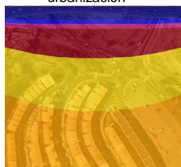
Simulación sin barrera para LeqA de una hora en el caso peor, barrera de 2 m de altura, barrera de 3 m de altura
