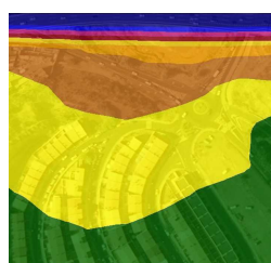
Simulación sin barrera para LeqA de una hora en el caso peor, barrera de 2 m de altura, barrera de 3 m de altura
