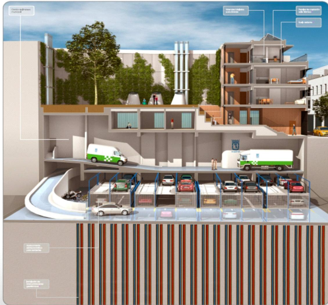
El edificio de Margaritas 52 es uno de los primeros ejemplos en España en el empleo de sistema de captación de energía geotérmica aplicada a la climatización en vivienda pública.
