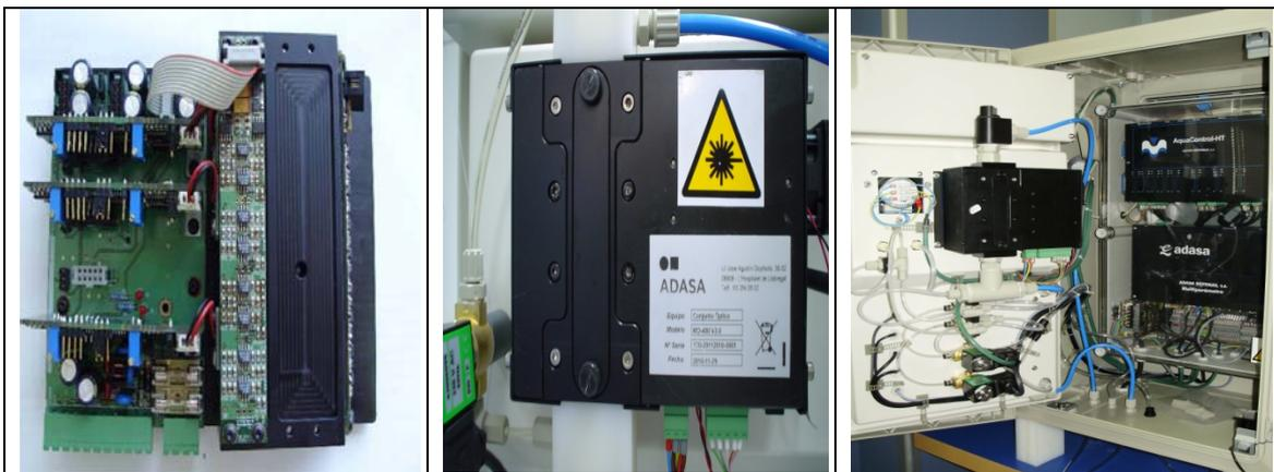
Fig. 2 El sensor desarrollado: detalle interior, unidad completa y su integración en el equipo
