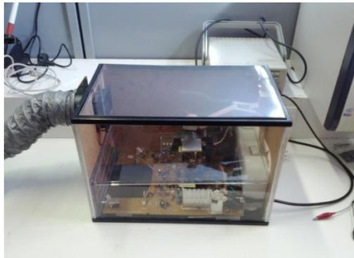
*Figura 4. Sistema implementado de corona de descarga.*
