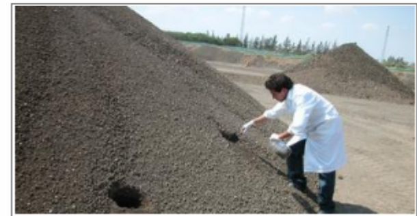
Toma de muestras de lodos de una depuradora. Imagen: US.
