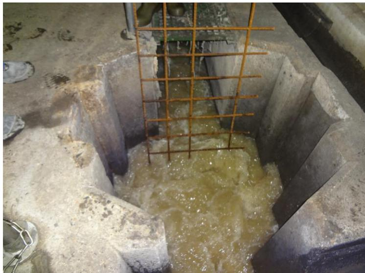
3. En 5 minutos, tras la apertura de la compuerta, el caudal de paso se estabilizó y en la malla se observó la acumulación de trapos y textiles.
