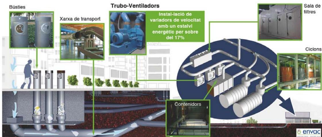
Esta solución se concreta en la introducción de unos variadores de velocidad que regulan el caudal de aspiración de los turbo-ventiladores que propulsan los residuos hacia la central. Gracias a esta medida se consigue un ahorro energético potencial de más de 110.000 kWh al año, que en función de las horas de trabajo y el precio de la energía, garantizará un retorno de la inversión en un plazo máximo de 6 años.
