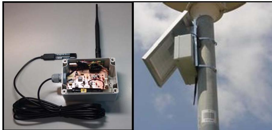
Fig. 5 y 6 Prototipo de Sensor y Sensor alimentado por modulo fotovoltaico
