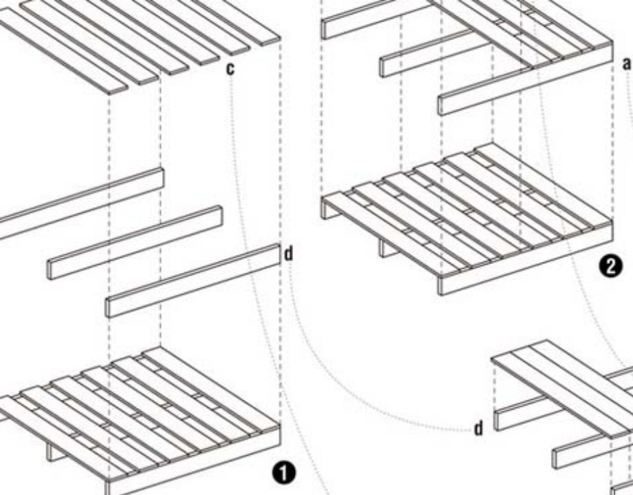
la base del primer palet, con la base del segundo. Unir las nueva tablas con las tres tabillas superiores desmontadas del segundo palet, hacerlo lo más junto que se pueda, conformará el asiento.
