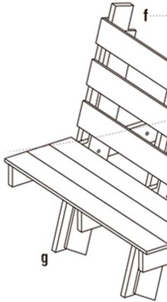
**7** Fijar a los retales colocados las patas traseras con tornillos. Cortar las patas delanteras y traseras para que su parte inferior quede horizontal. Colocar pasador que fija posición.
